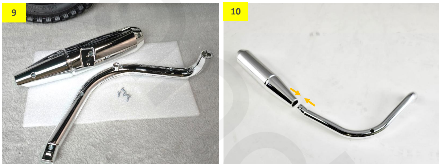
Obr. 11 a 12: Výfuk nasadíte nadoraz do otvoru v motoru a na zadní rám. Přišroubujte nejdříve přední část výfuku (použijte 1 šroubek).
